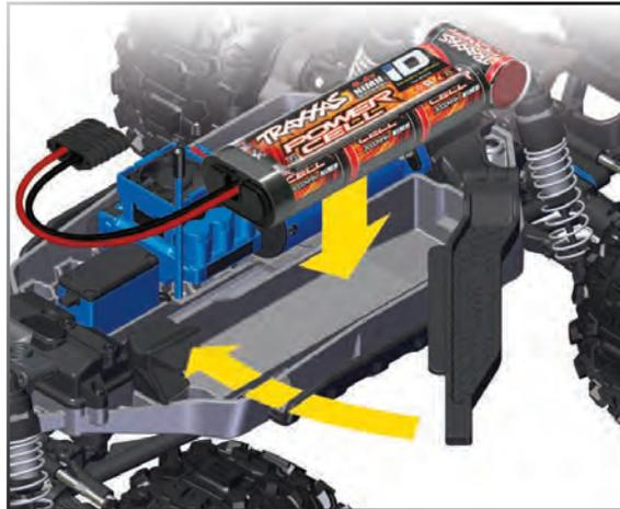
**INSTALLING THE BATTERY PACK**
